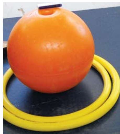
Foto yon tip flotè ak yon roulo kòd (ki fèt ak melanj asye ak polipwopilèn) DCP yo ki pral poze nan sidès la.
